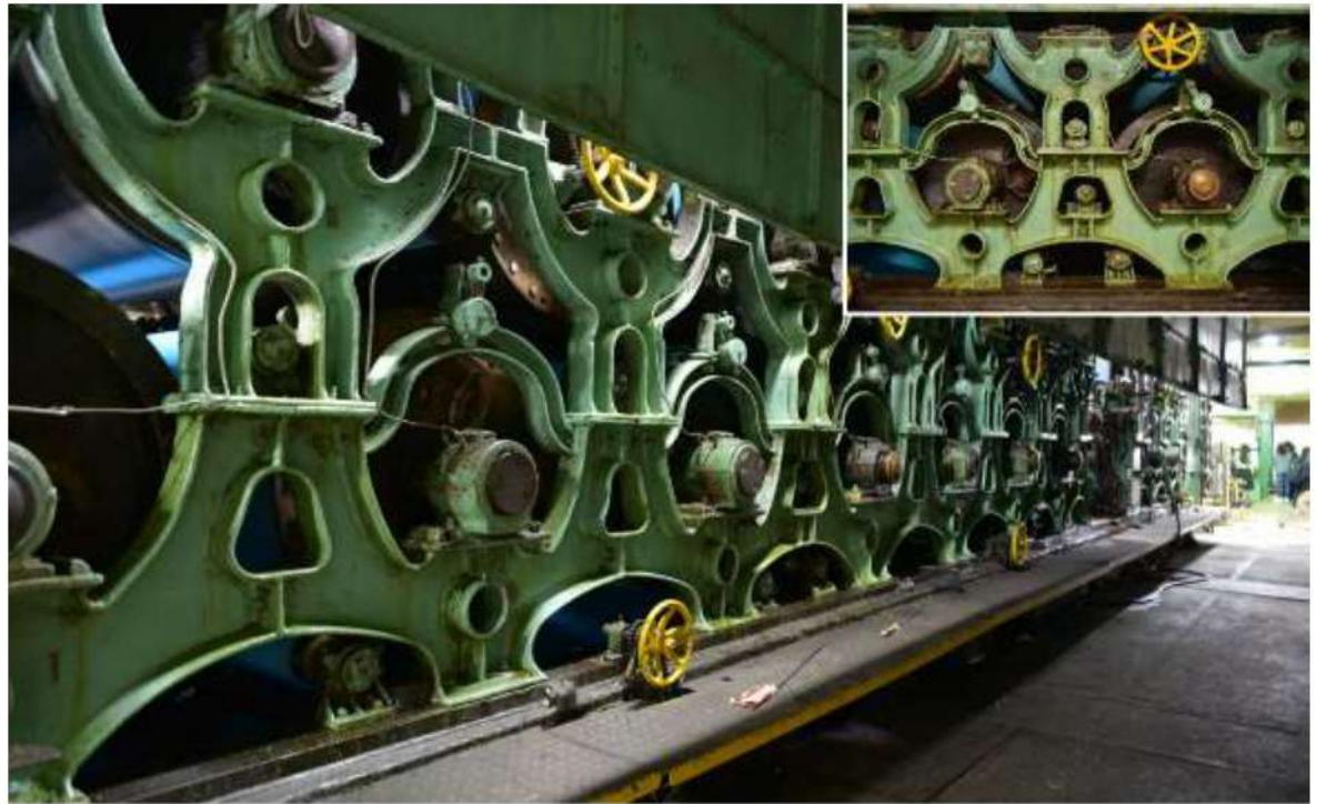
【照片 2-4-13】乾燥—圓筒加熱使紙乾燥
