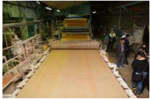
【照片 2-4-10】網部—紙張交織成形，紙張含水率約 80%
