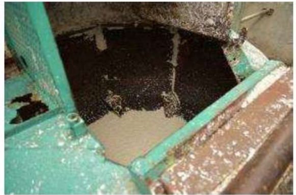
【照片 2-4-4】散漿機—乾紙漿加水攪拌
