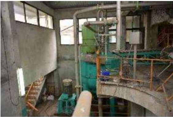
【照片 2-4-3】散漿機—乾紙漿加水攪拌
