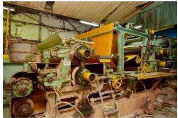
【照片 2-4-12】壓水部—滾輪壓榨脫水至約 60%
